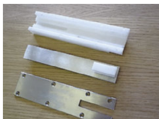
Die dreiteilige Schlepplführung: Grundkörper, Schleppteil mit Führung, Abdeckplatte
