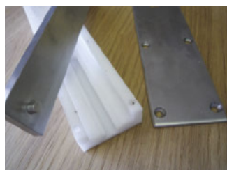
Der unten sitzende Rundbolzen hält das Schleppteil im Grundkörper
