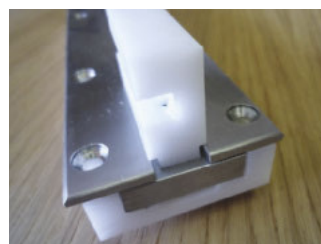
Das komplette Teil. Der Führungsblock aus Delrin wird erst bei der Endmontage eingebaut
