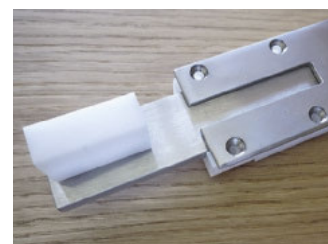
In dieser Lage wird das Schleppteil durch den Rundbolzen gegen ein Herausgleiten gesichert
