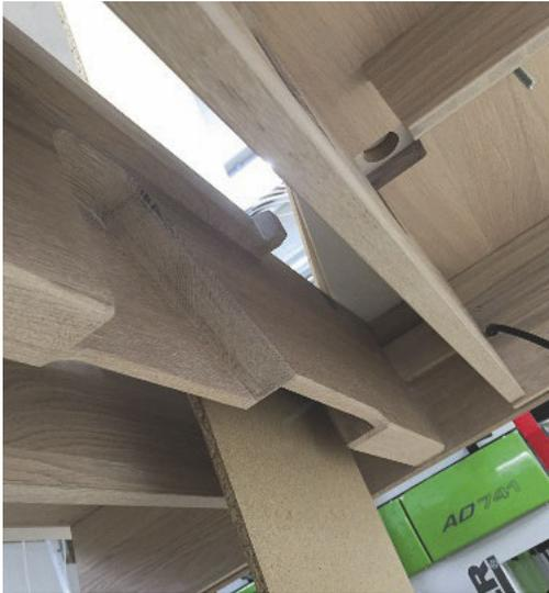
Damit die beiden Ablaufrohre eng zusammengefasst werden können, sitzen beidseitig an der Quertraverse tiefe ausgefräste Taschen
