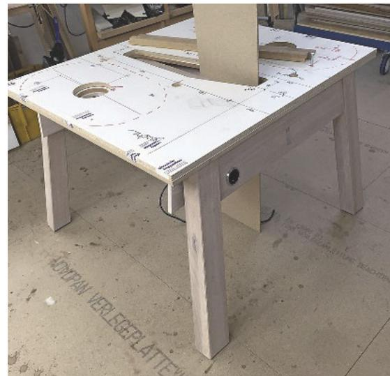
Auf der CNC gefertigte, provisorische Platte. Die Fräsdaten wurden dann direkt an den Hersteller der Keramikplatte übermittelt
