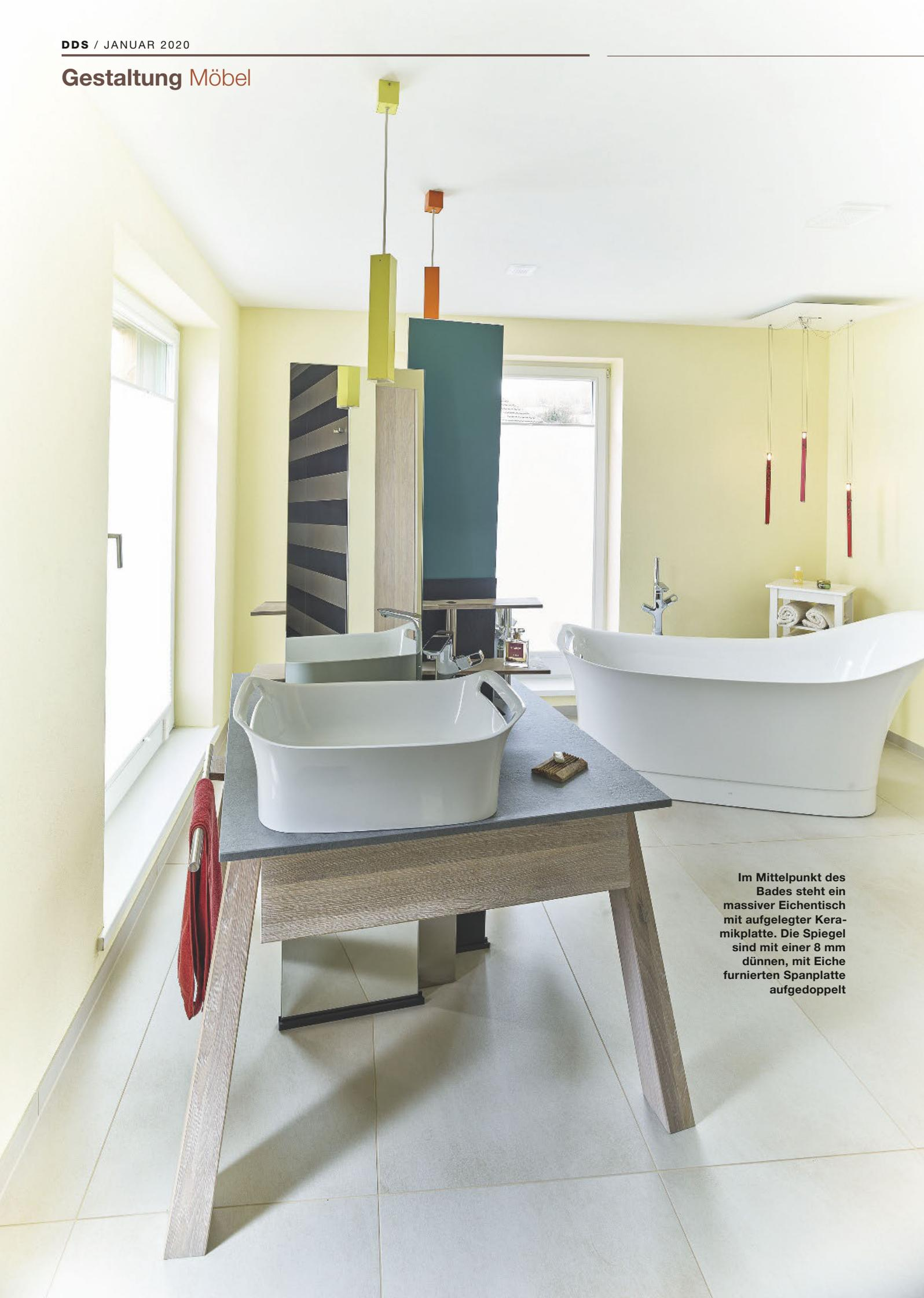
Im Mittelpunkt des Bades steht ein massiver Eichentisch mit aufgelegter Keramikplatte. Die Spiegel sind mit einer 8 mm dünnen, mit Eiche furnierten Spanplatte aufgedoppelt
