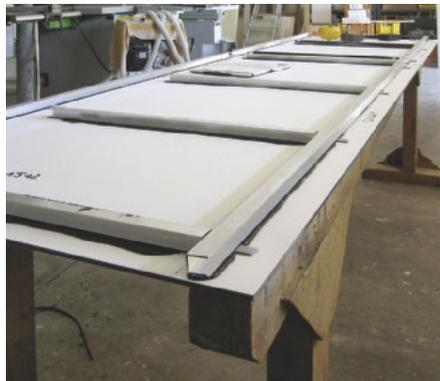
Die Alu-Unterkonstruktion: Die Längsprofile sind zum Einhängen der Paneele, die Querprofile versteifen die Fläche
