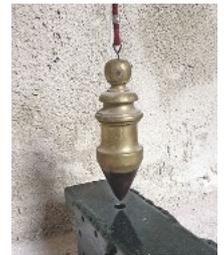
Zwei solcher Lote hingen im Treppenhause und ermöglichten ein schnelleres und einfacheres Einmessen der unteren Unterkonstruktion als der Laser
