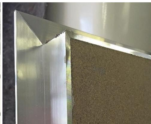
Die auf Gehrung geschnittenen Aluwinkel werden bündig zur Oberfläche der Spanplatte geklebt
