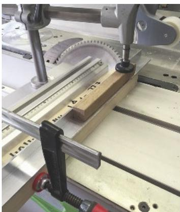
Zuschnitt der komplett vorgefertigten Rahmenteile auf der Formatkreissäge
