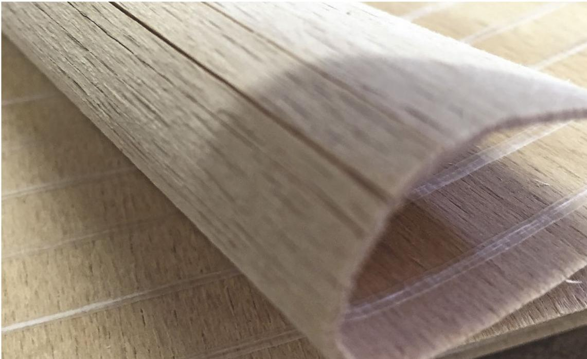
Die einzelnen Streifen des 3D-Furniers sind gegeneinander leicht verschiebbar und ermöglichen so den bei einer dreidimensionalen Formverleimung erforderlichen Längenausgleich
