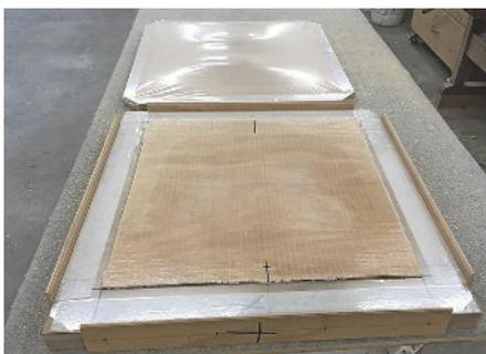
Mit Doppelklebeband fixierte PVC-Folien gewährleisten beim Verleimen ein leichtes Gleiten des Furnierpakets
